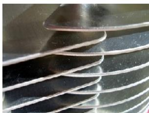
Lasergeschnittene und handentgradete Kanten sorgen für eine hohe Spannungsfestigkeit.
